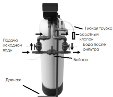
Подключение к водопроводу
