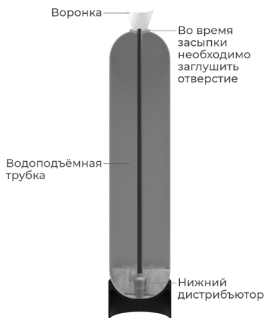
Заполнение фильтра материалом
