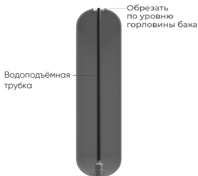
Обрезка водоподъемной трубы
