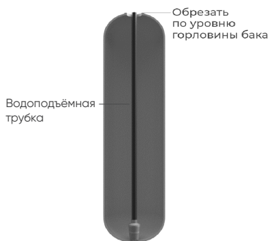
Обрезка водоподъемной трубы
