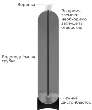
Заполнение фильтра материалом
